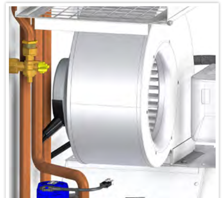
FIGURE 26. AIR CIRCULATION FAN
