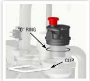
FIGURE 41. AUTOMATIC AIR VENT
