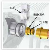
FIGURE 36. BURNER INJECTOR
