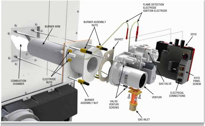
FIGURE 27. MAIN BURNER ASSEMBLY
