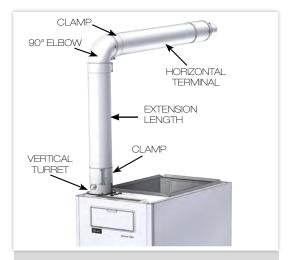
FIGURE 7. EXTENDED HORIZONTAL FLUE
